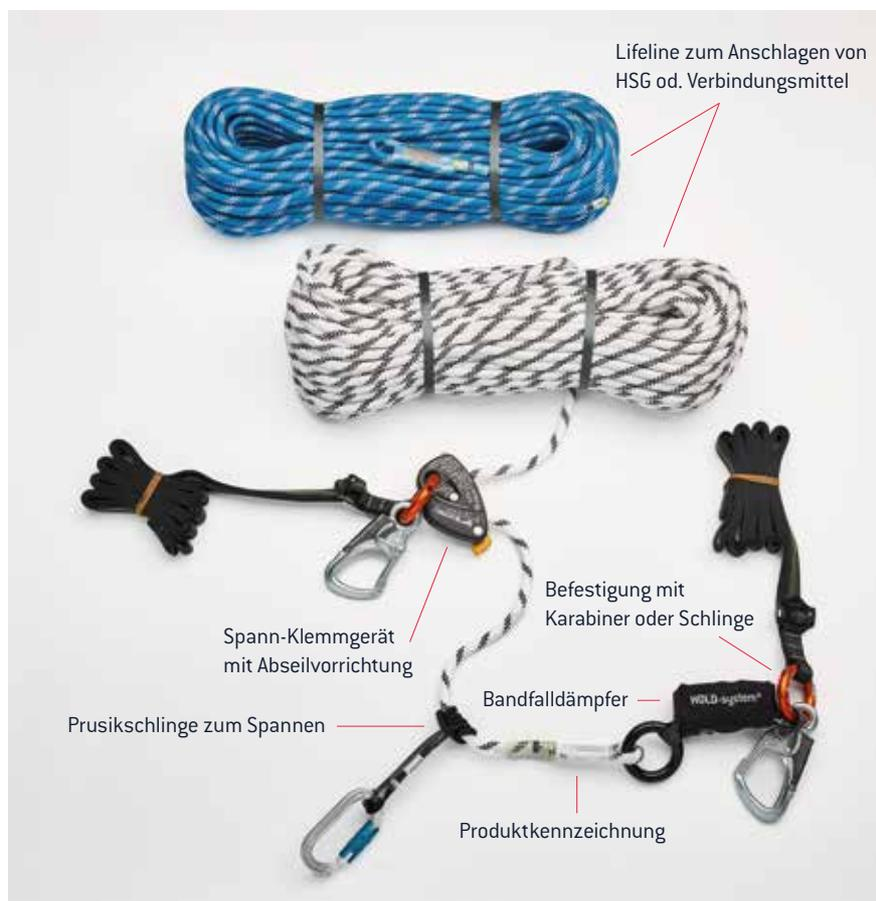
Bild 1: HOLD-system Komponenten
