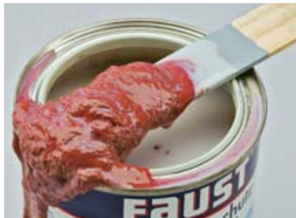
Diese wasserlösliche Rostschutzfarbe hatte sich gründlich abgesetzt. Erst nach langwierigem Aufrühren war sie streichbar
