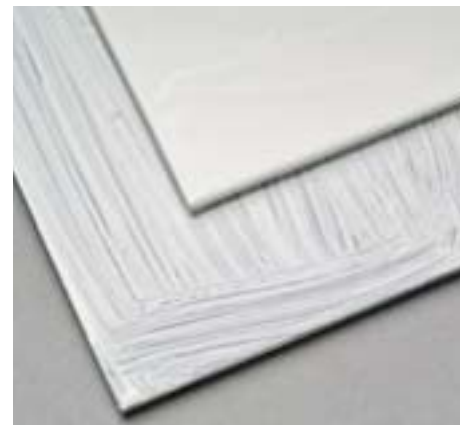
Die fertig beschichteten Tafeln zeigten teilweise große Unterschiede in der Oberflächenoptik
