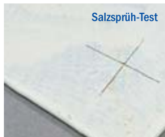
Gutes Ergebnis: Weder an Kanten noch Schadstellen rostet es
