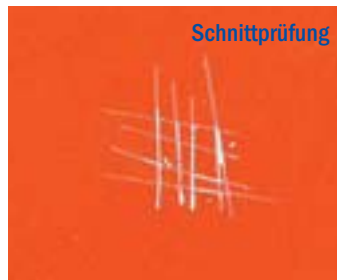
Einzelne Rostschutzbeschichtungen zeigten Schwächen in der Haftung
