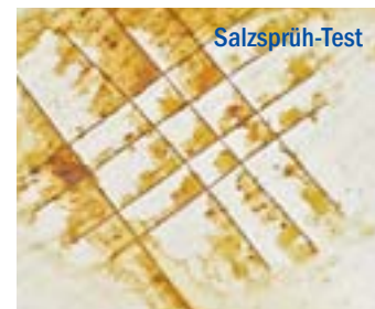
Schlechtes Ergebnis: Von Schadstellen und Kanten aus rostet das Blech
