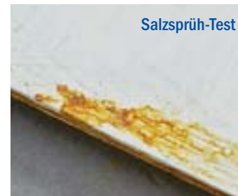
Typisch: Der Rostbefall beginnt an den Kanten des Werkstücks
