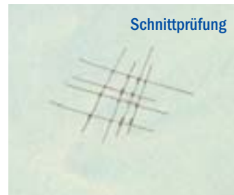
Kleine Abplatzungen wurden noch mit befriedigend bewertet
