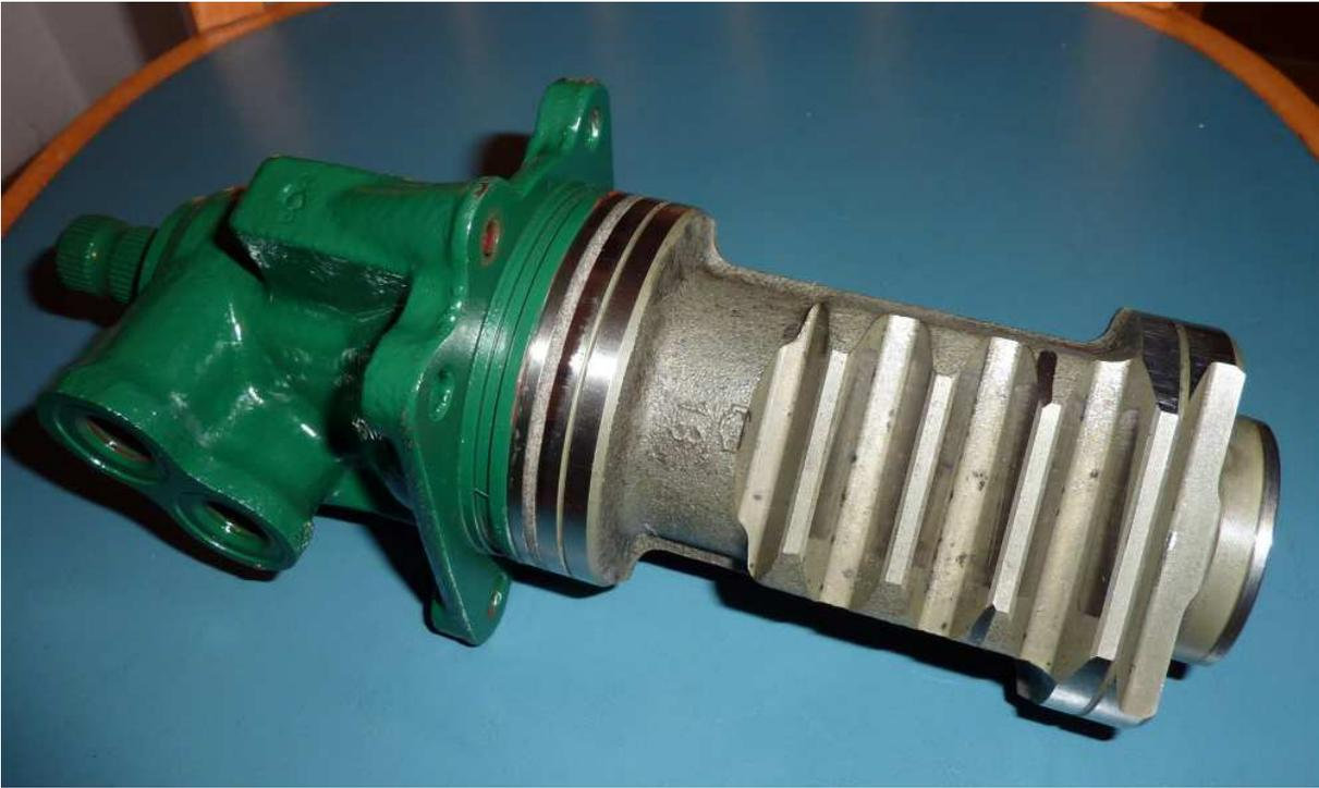
Die Lenkschraube ist mit 4 Vielzahn-Muttern befestigt, die einen ebensolchen Schraubenschlüssel erfordern.
