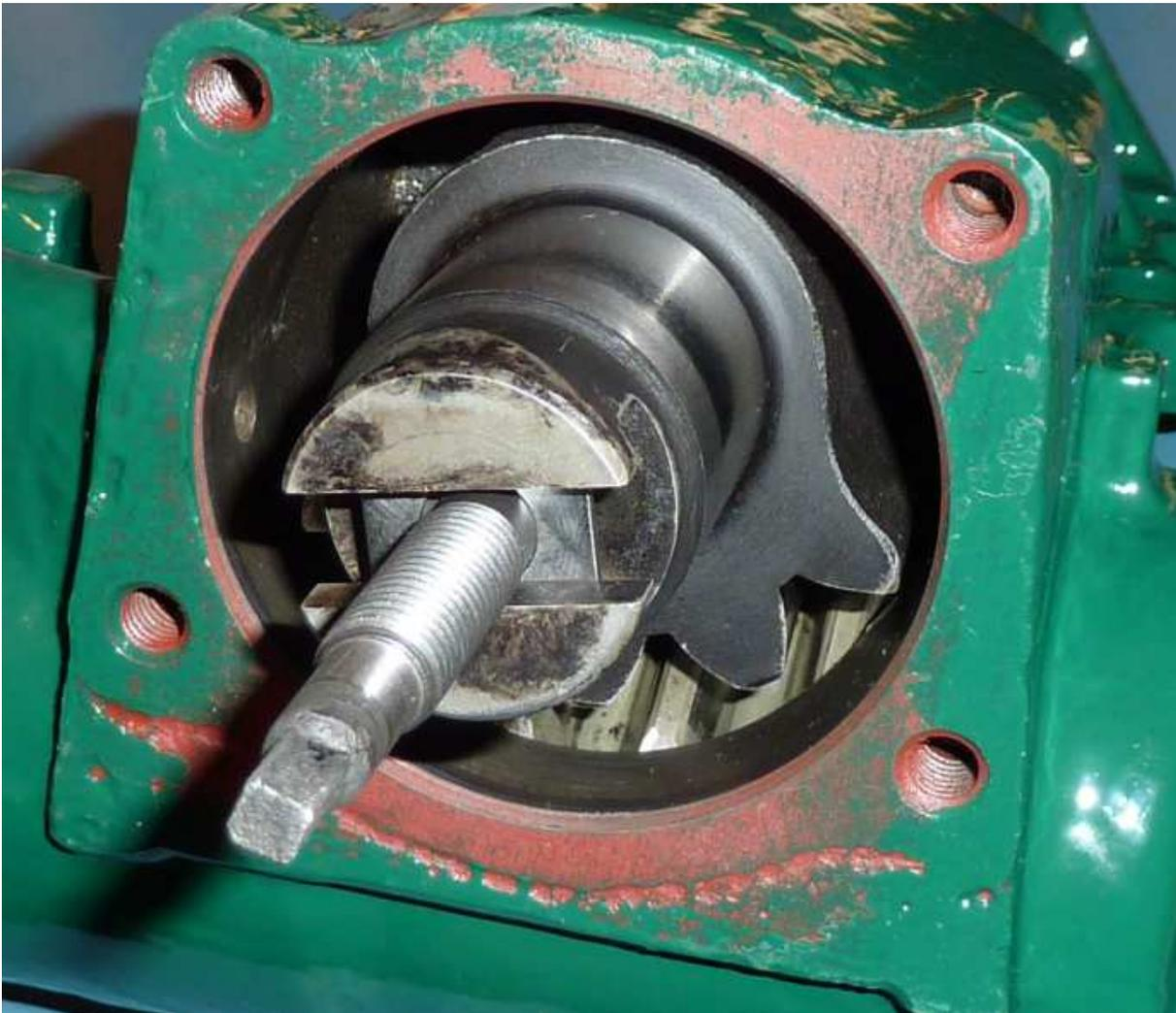
Durch leichte Schläge mit einem Gummihammer kann die Welle nun von unten aus dem Gehäuse getrieben werden.
