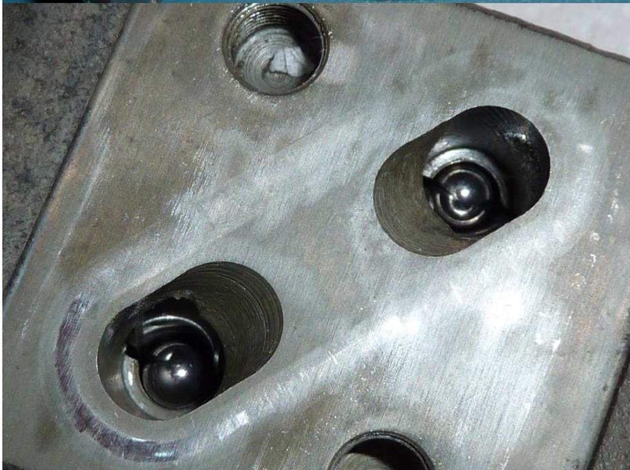
4. Nach diesen 3,5 cm Herausdrehen sind 19 Kugeln im Loch verschwunden und man sieht die erste eingefüllte Kugel von unten im linken unteren Loch wieder auftauchen - und nun STOP!
