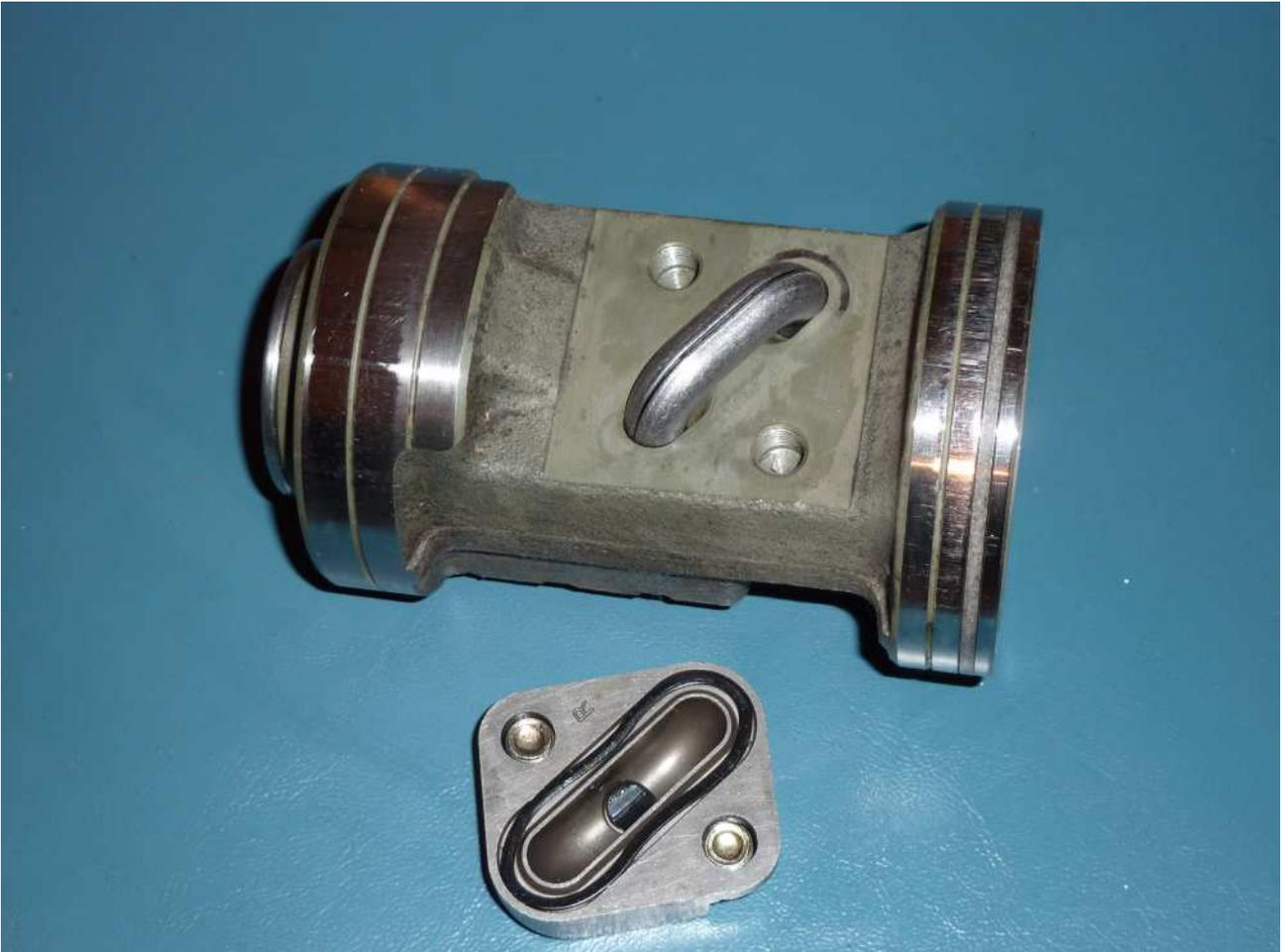
Wir entfernen die Sicherungsplatte des Umlaufs (Torx Schrauben). Dort befindet sich die Kugelrückführung, die aus 2 Hälften aufgebaut ist. Beim Entfernen bitte merken, wohin die letzten 2 Kugeln fallen, die noch in der Rückführung enthalten sein könnten ☺ (sehr ärgerlich so was, daher der Hinweis oben auf „meine“ 28 Kugeln).
