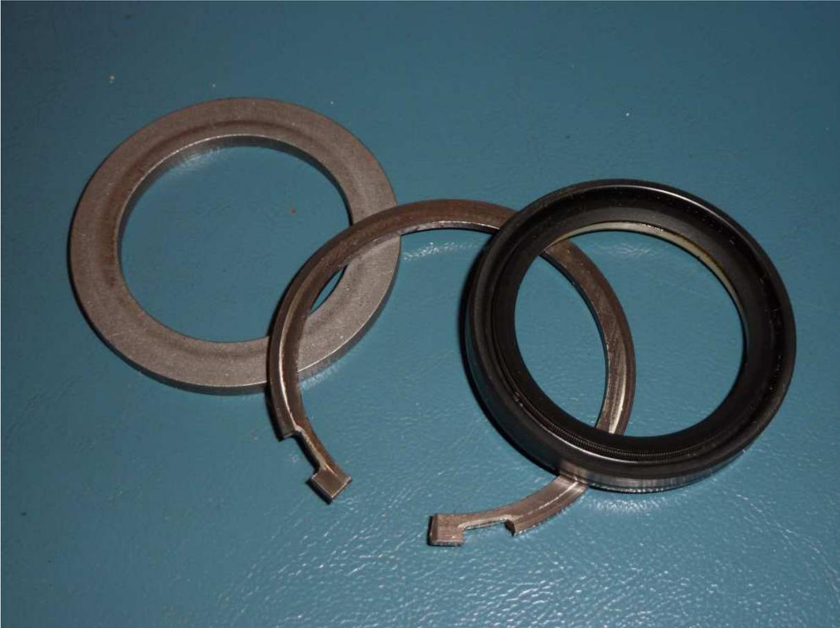
Wir sehen hier den Stützring, den Sicherungsring und den Wellendichtring. Zusätzlich ist noch ein Staubschutzring ganz außen verbaut, der sich in meinem Fall nicht zerstörungsfrei entfernen lässt und daher nicht auf diesem Bild ist.
