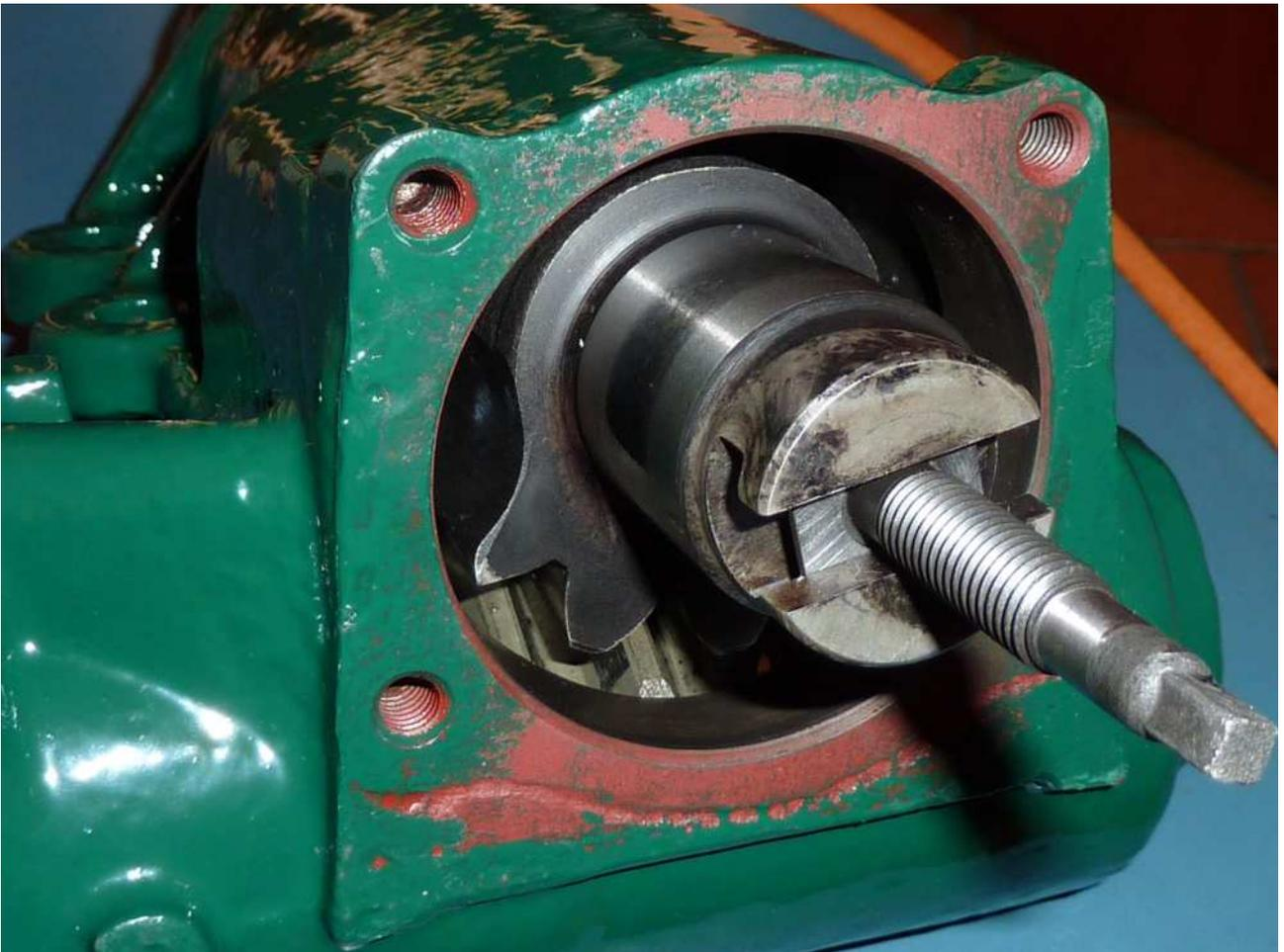
Den Deckel wieder aufsetzen und durch Drehen des Vierkantes in das Gehäuse hineinziehen. Natürlich ist die Segmentwelle an der Stelle etwas „entgegenkommend“, so dass wir noch mit einem Hammer und einem Holz die ganze Sache wieder etwas ins Gehäuse treiben müssen.
