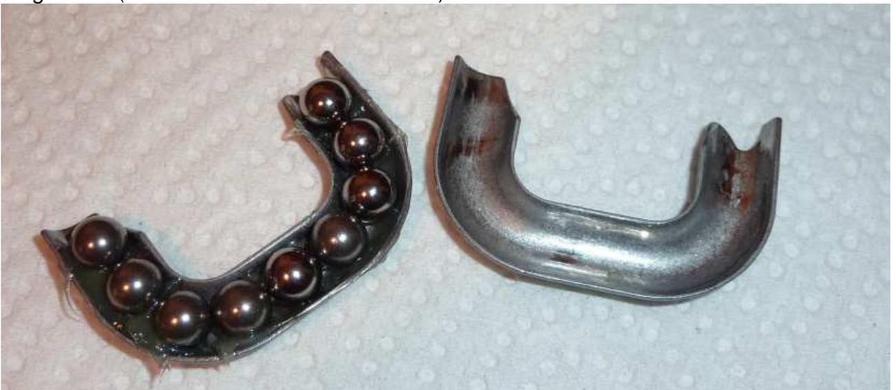
6. Den Umlauf stecken wir nun in die beiden Bohrungen. Man kann sich hierbei nicht irren, da das Teil spiegelrichtig aufgebaut ist.
