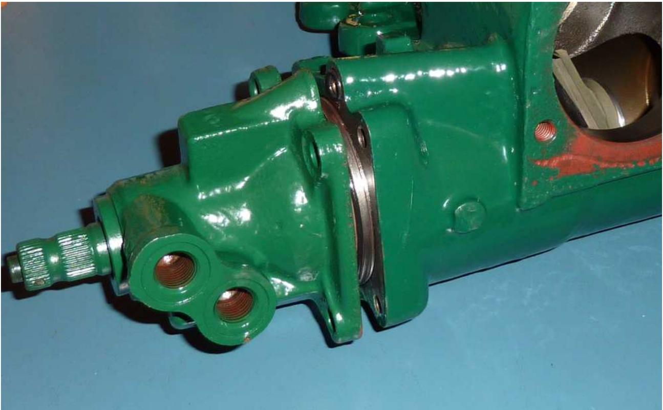
Die Lenkschraube kann nun wieder ins restliche Gehäuse geschoben werden, es passt nur auf eine Art, Irrtum ausgeschlossen. Vorher nicht vergessen, den Gummiring einzufetten und einzusetzen. Durch Drehen an der linken Stellschraube, können wir die Funktion überprüfen. Die Verzahnung rechts wandert hin und her.
