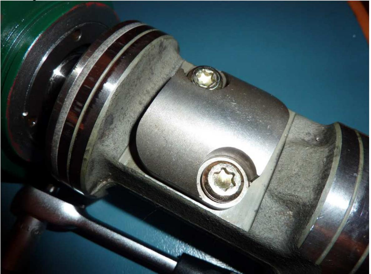
**Und Achtung**, hier wahrscheinlich einer der Fehler, der zum Blockieren der Lenkung führen kann. Die unteren Kugeln dürfen nicht nach links oben aus dem eigentlichen Umlauf wandern. Wurde das Gewinde vorher eingefettet, kann eine Kugel kleben bleiben und aus dem eigentlichen Umlauf herausgedreht werden. Das sieht dann so aus: die obere Kugel (in der unteren Öffnung) verschwindet im Gewindegang nach Links-oben.
